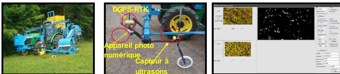
Figure 1 : Système de fusion de capteurs pour cartographier la hauteur des plants, les pentes, l'élévation et le rendement en fruits en temps réel avec logiciel sur mesure.
