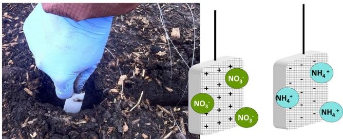
Fig. 1 Membranes d'échange ionique.
