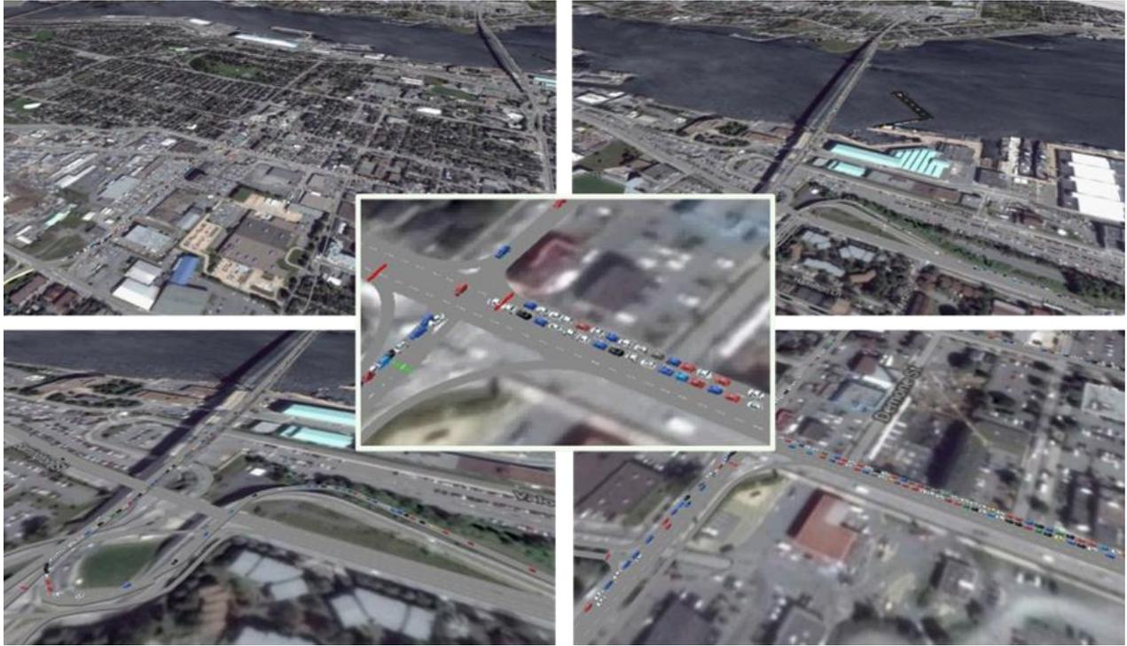
**Figure : Visualisation du modèle de microsimulation de circulation en cas d'évacuation, de la circulation en cas d'évacuation et de la congestion dans le réseau de transport d'Halifax**
